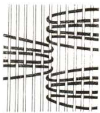
Простое группированное соединение Компенсационное группированное соединение
