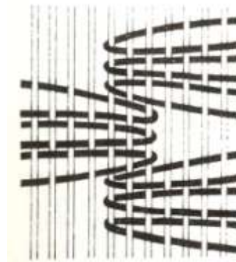
Простое группированное соединение Компенсационное группированное соединение
